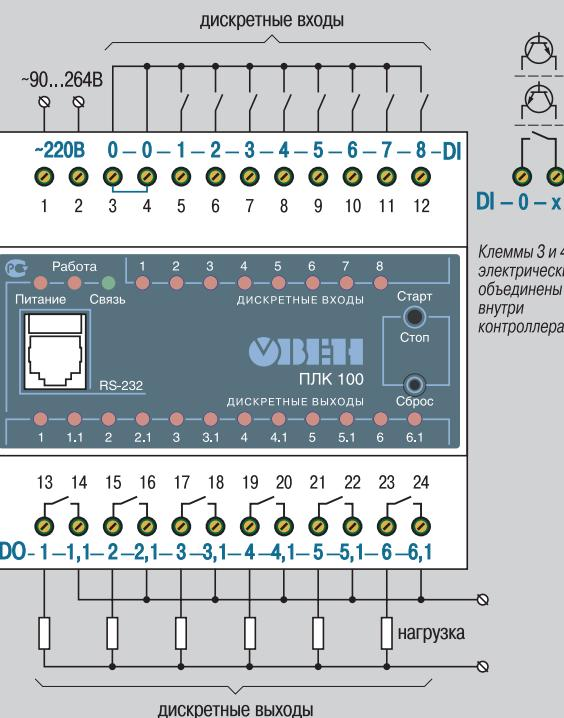
▲ Схема подключения питания, дискретных входов и выходов ПЛК100-220.Р
