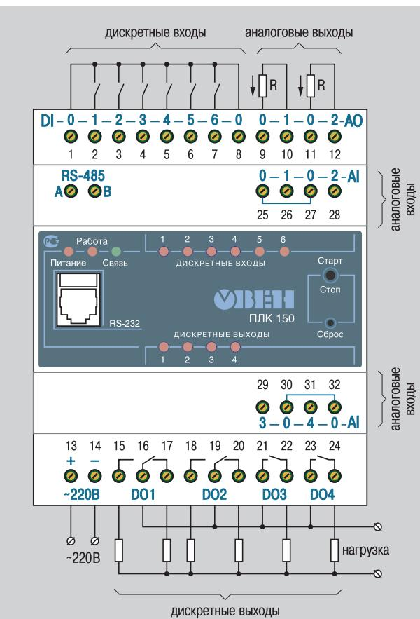
▲ Схема подключения питания, входов и выходов ПЛК150-220
