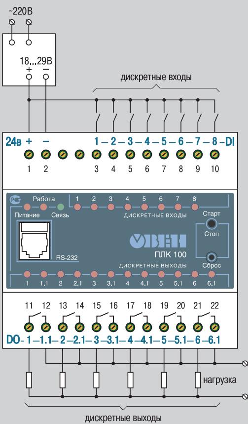
▲ Схема подключения питания, дискретных входов и выходов ПЛК100-24.Р
