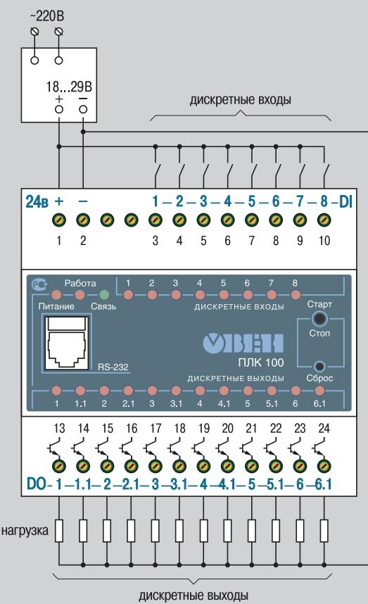
▲ Схема подключения питания, дискретных входов и выходов ПЛК100-24.К
