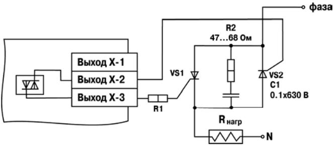
Рисунок 5.3 - Схема подключения двух тиристорov, подключенных встречно-параллельно
