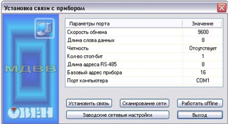
Рисунок 4.1 - Окно установки связи с прибором
