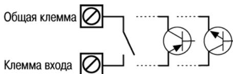
Рисунок 6.1 - Схема подключения датчиков к дискретным входам
