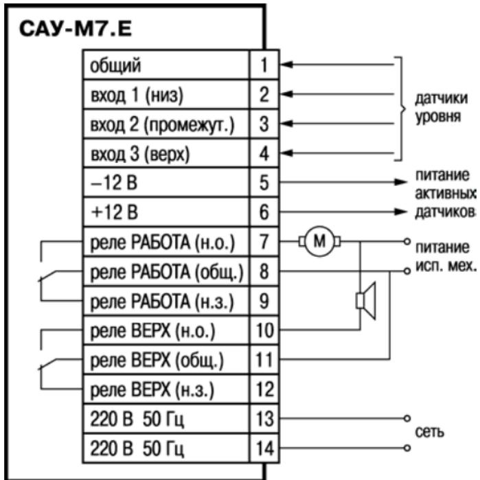
Рисунок Б.1 – Общая схема подключения САУ-М7.Е
