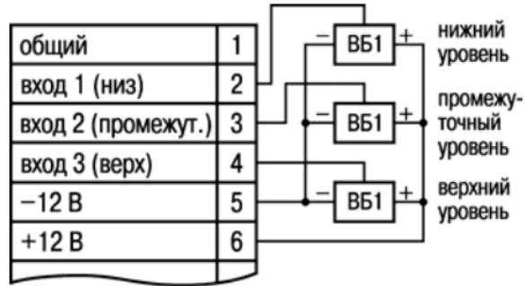
Рисунок Б.3 – Схема подключения емкостных переключателей
