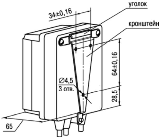
Рисунок А.2 – Прибор настенного крепления Щ1
