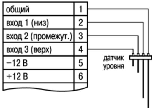
Рисунок Б.2 – Схема подключения кондуктометрических датчиков уровня
