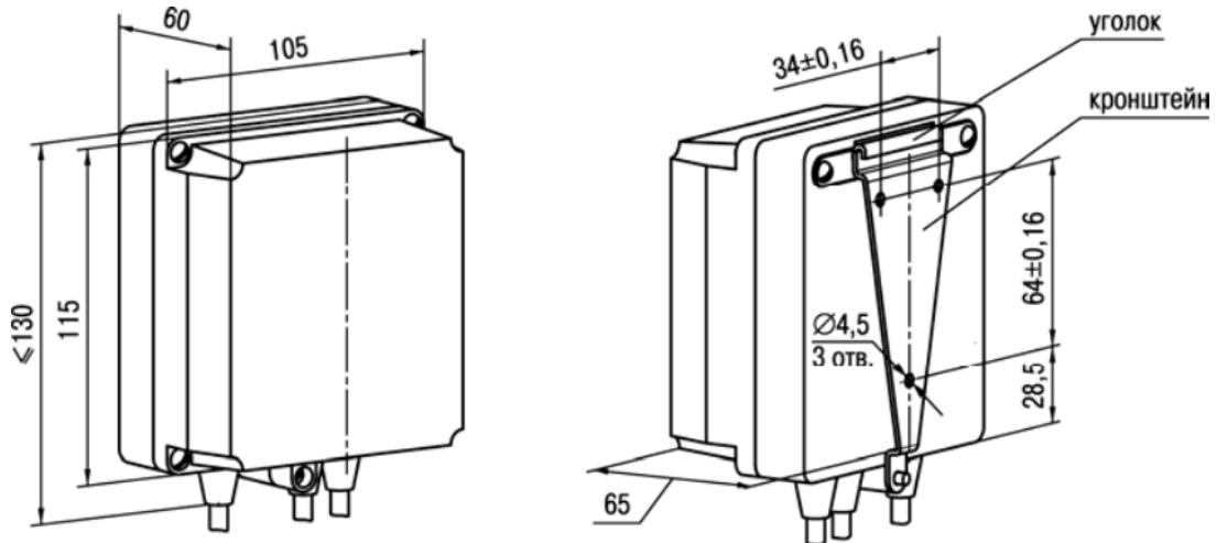
Рисунок А.1 – Прибор настенного крепления Н
