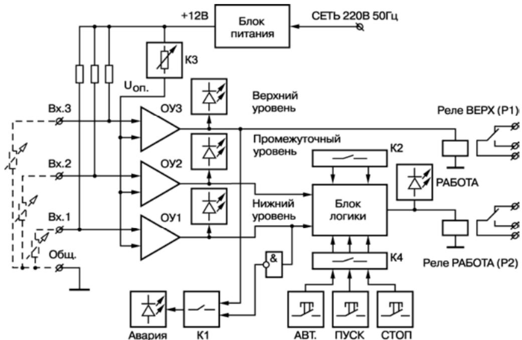
Рисунок 3.1 – Структурная схема прибора
