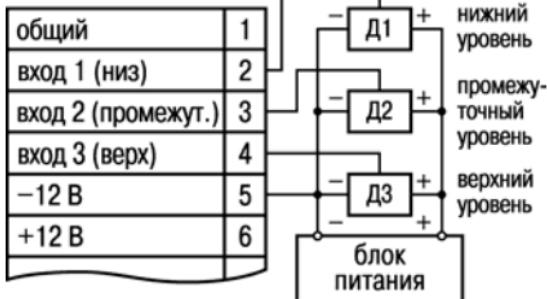
Рисунок Б.4 – Схема подключения активных датчиков Д1...Д3 при питании их от внешнего источника
