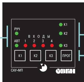
**Светодиоды «K1», «K2», «K3»** в режиме РАБОТА постоянной засветкой показывают состояние соответствующего реле, а мигающей – аварию.
