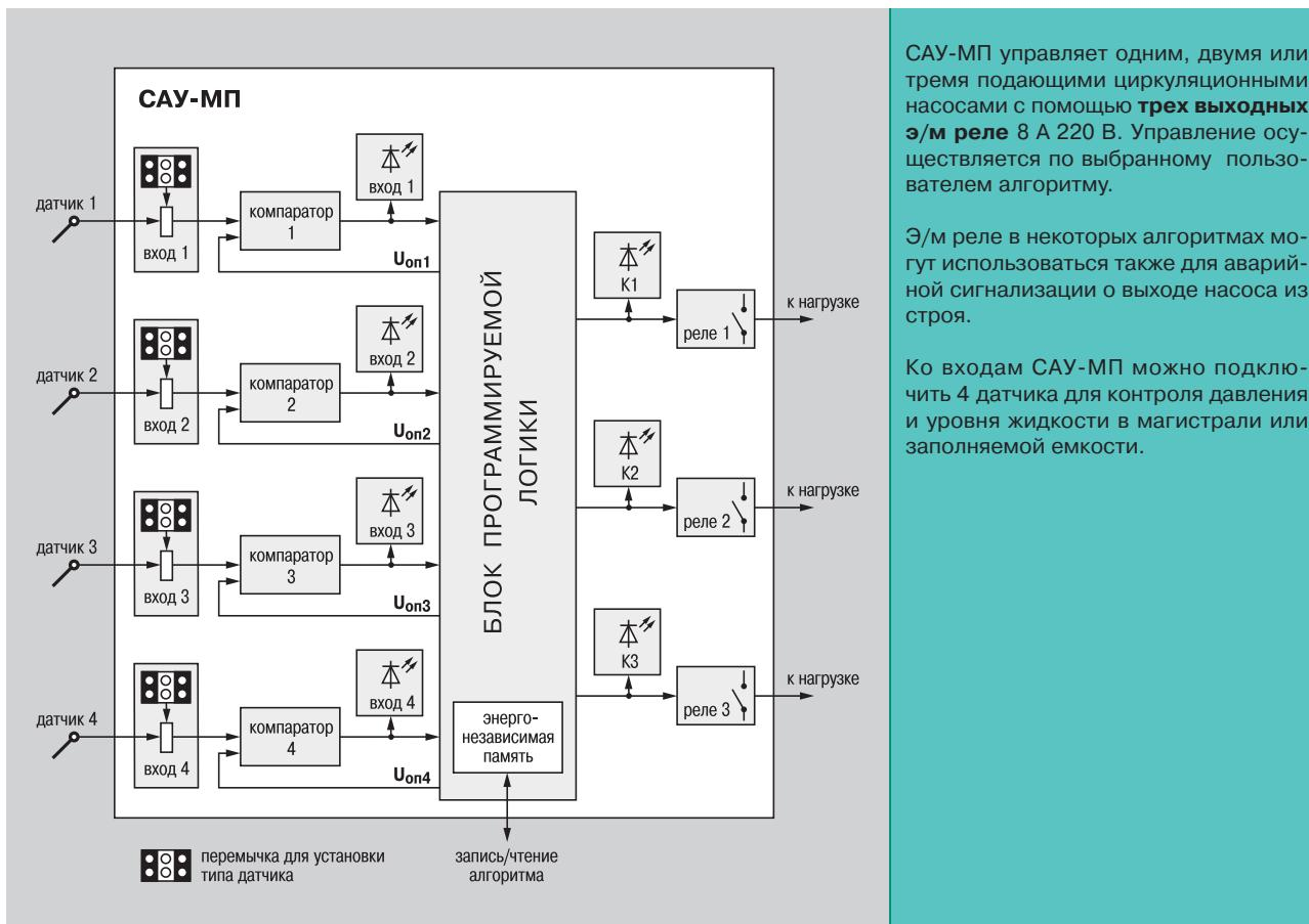
САУ-МП управляет одним, двумя или тремя подающими циркуляционными насосами с помощью **трех выходных э/м реле** 8 А 220 В. Управление осуществляется по выбранному пользователем алгоритму.
