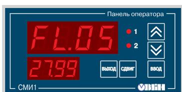
Панель оператора СМИ1 может работать в двух режимах. Переход из режима «Отображение параметров» в режим «Редактирование параметров» осуществляется кнопкой **ВВОД**.
