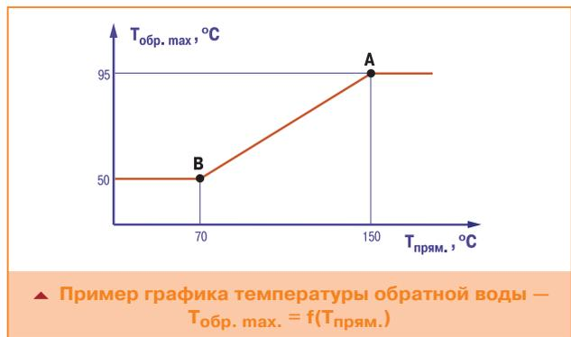
Регулирование температуры в системе горячего водоснабжения (ГВС)
