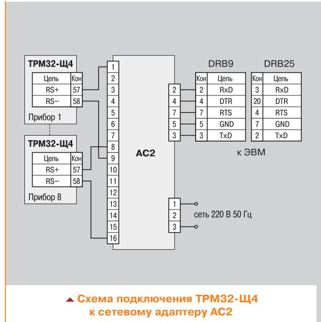
▲ Схема подключения ТРМ32-Щ4 к сетевому адаптеру АС2
